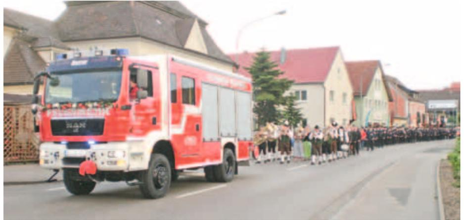
eine Abordnung der Feuerwehr aus der Partnergemeinde Burgeis in Südtirol begrüßen. Das neue HLF 20/16 der Fa. Lentner auf einem MAN TGM Fahrgestell hat 340 PS und Allrad. Als markante Gerätschaften sind der Dachmonitor, die Seilwinde, die Hebekissen mit 24 Tonnen Hubkraft und der Lichtmast zu erwähnen.
