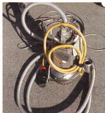
ELRO-Gefahrgutpumpe Ex-geschützt. Selbstansaugende Schlauchpumpe mit 300l/min Förderleistung bei 2 bar Ausgangsdruck und einer Saughöhe von 7,5 m. Es können brennbare Flüssigkeiten, Säuren, Laugen sowie zähflüssige und mit Feststoffen versetzte Medien bis zu einer Korngröße von 10 mm verpumpt werden.
