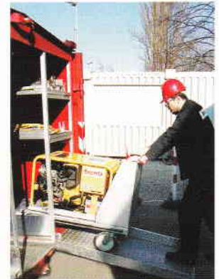
Zur sicheren und schnellen Entnahme der Rollwägen mit schweren Geräten dient eine Alurampe.
