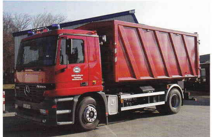
Wechselladerfahrzeug mit Abrollbehälter-Öl (WLF AB-Öl). Trägerfahrzeug Mercedes-Benz Actros 1831 mit fest eingebautem 4 kW Dynawatt Stromerzeuger und 2 x 1000 Watt Lichtmast zur Einsatzstellen Ausleuchtung.
