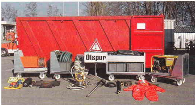
Abrollbehälter-Öl mit den Maßen l: 5900 mm, b: 2500 mm, h: 2400 mm. Alle schweren und sperrigen Geräte sind auf Rollwägen verlastet, und können problemlos auch über größere Entfernungen transportiert werden.
