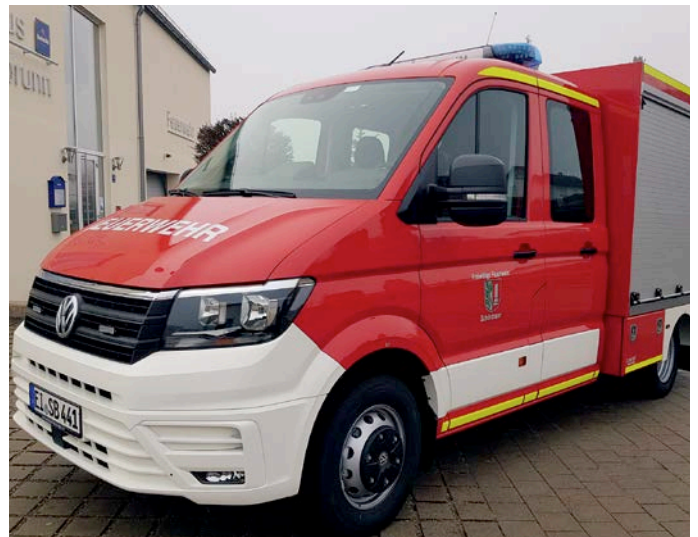
Tragkraftspritzenfahrzeug (TSF) der Freiwilligen Feuerwehr Schönbrunn
