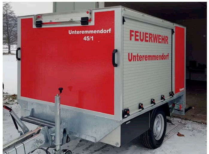
Tragkraftspritzenanhänger (TSA) der Freiwilligen Feuerwehr Unteremmendorf
