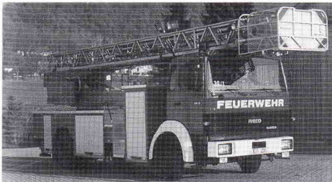
Die neue DLK 23-12 der FF Beilngries mit neuer Computersteuerung.
