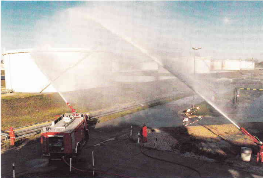
Kühlung eines Rohöltanks mittels Monitor und Dachwerfer des Tanklöschfahrzeugs
