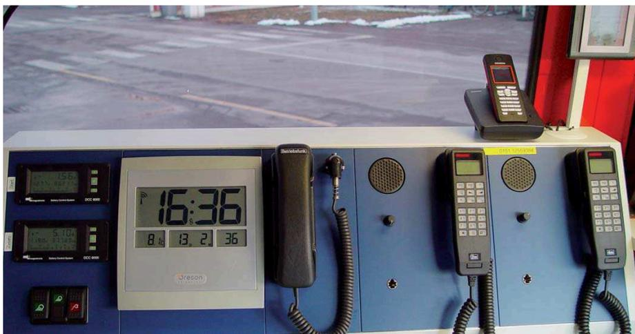
Funkkonsole mit 70 cm Betriebsfunk, 2 m BOS Mobilfunk, 4 m BOS Mobilfunk, Analogtelefon, digitaler Funkuhr. Oben rechts das Display der Funkwetterstation. Im Bild links das Batterie-Management-System zur Überwachung des aktuellen Ladezustands. Ein Unterspannungsschutz schaltet Verbraucher rechtzeitig ab damit das Fahrzeug immer noch gestartet werden kann.
