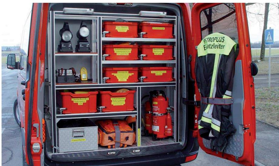
Heckladerraum mit zusätzlicher feuerwehrtechnischer und medizinischer Beladung.
