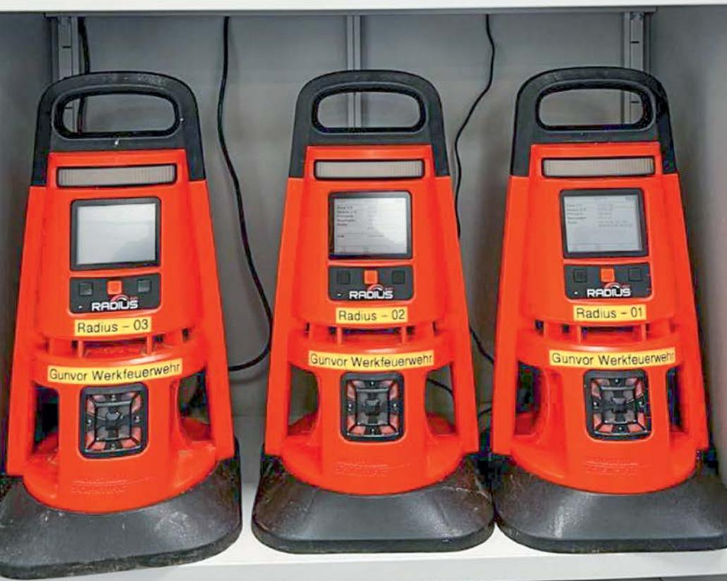
Neu beschafften Radius BZ1 (Aktueller Bestand: 3 x Stück Komplettgerät, 1 x Stück Ersatzgrundgerät zum schnellen „Akkutausch“) und 2 x Stück RGX Übertragungseinheit
