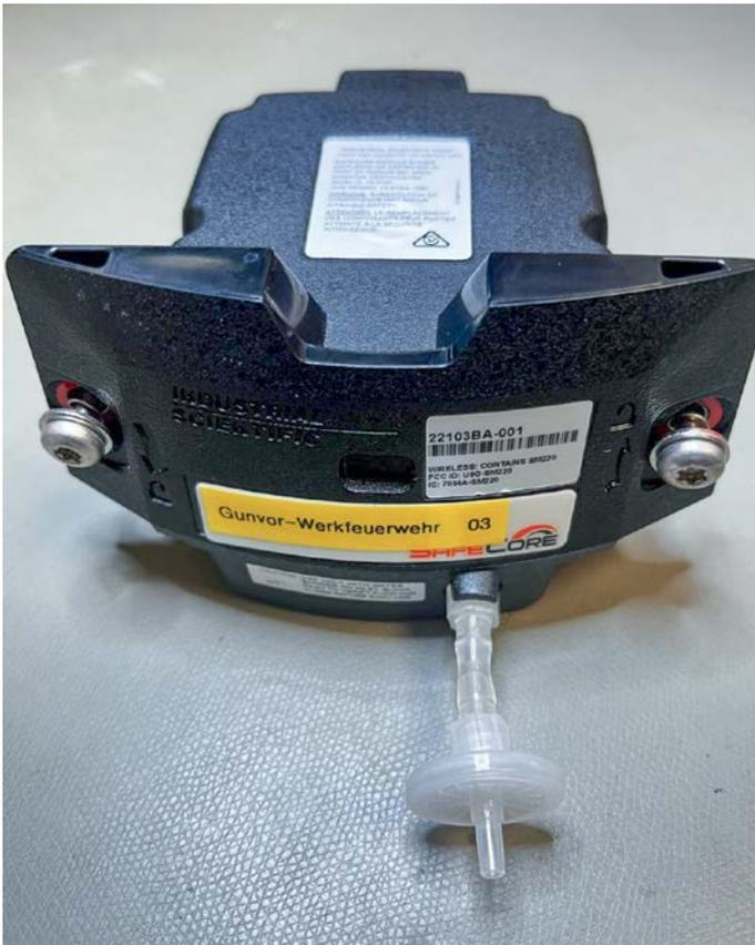
Das Herzstück – „der SafeCore“ bestückt mit LEL, H2S, CO, O<sub>2</sub> und PID-Sensor; Pumpe, LENS-Wlan und GPS-Modul
